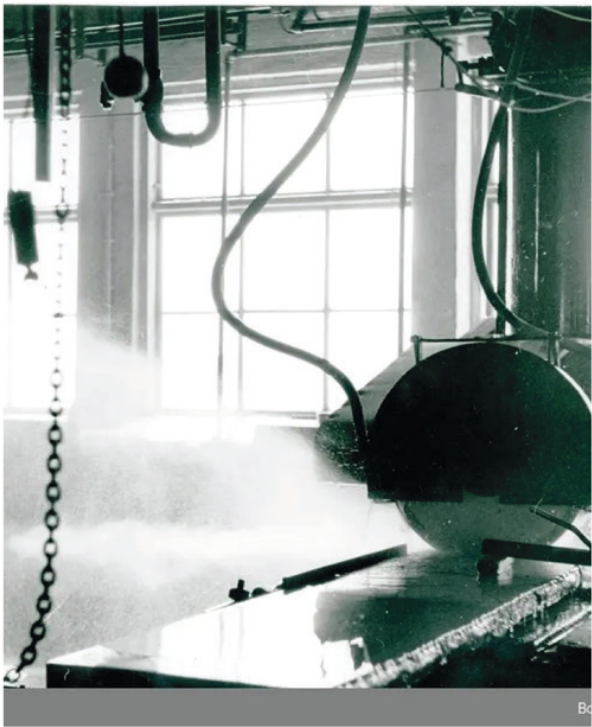
Figure 24. Sågning av stenskiva. (Evers, n.d).
